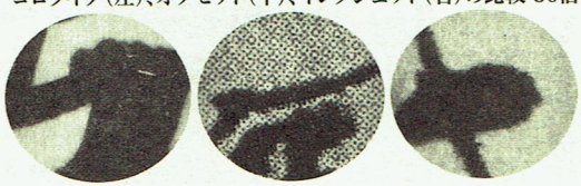
コロタイプ(左)、オフセット(中)、インクジェット(右)の比較-30倍
